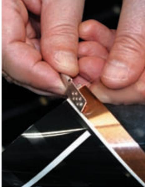
Рис. 9. Установленный на термоленку контактный зажим со стороны медной полосы (снизу)
