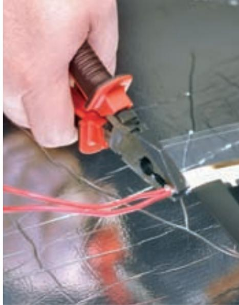
Рис. 16. Надежно зажмите провода в контактном зажиме
