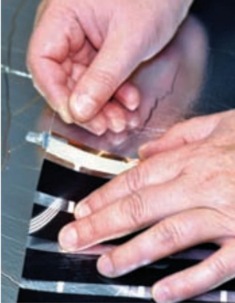
Рис. 8. Установленный на термоленку контактный зажим
